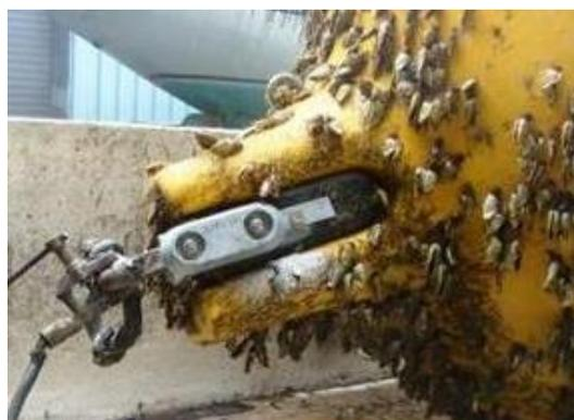
*Photo 10: Anode sur une bouée de 600 litres.*
