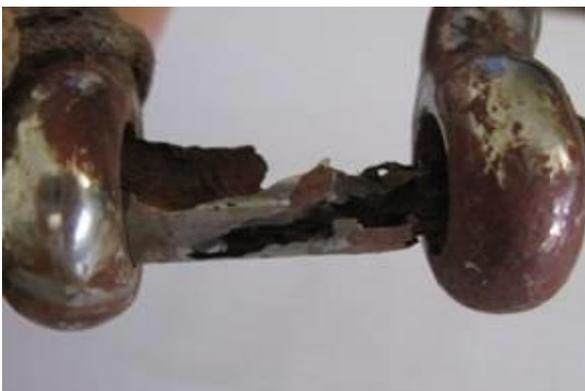
Impressionnante (mais pas rare) électrolyse sur un manillon d'une manille en inox. Les éléments en inox doivent être écartés, ils sont chers et sensibles à l'électrolyse.
