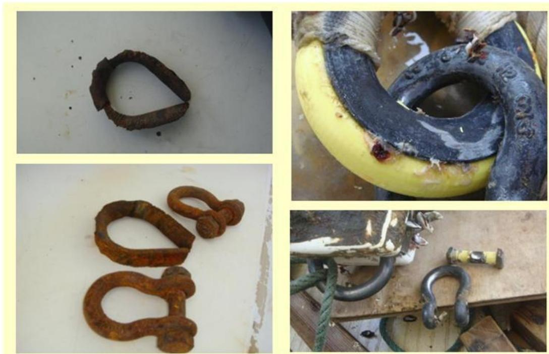
*Photo 8: Comparaison de pièces métalliques, après deux ans en mer, protégées ou non par des anodes.*
