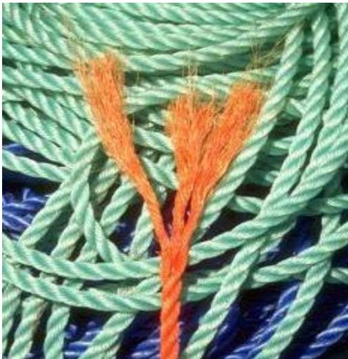
*Photo 2: Rupture par une tension excessive.*
