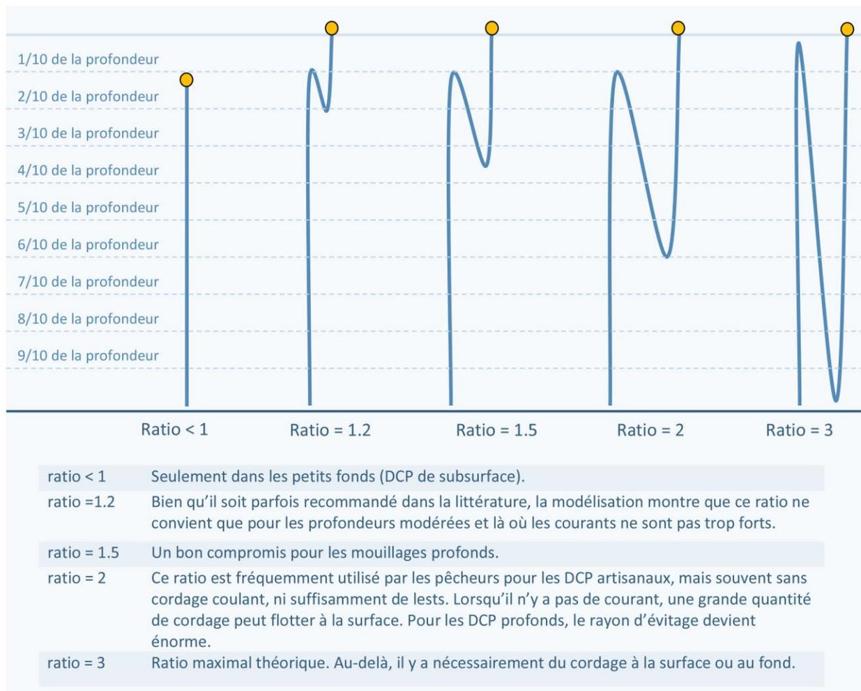
Figure 14: Le ratio longueur profondeur.
